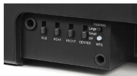
Pod zaślepką została ukryta sekcja przełączników konfigurujących opcjonalne, zewnętrzne głośniki systemu, rozwiniętego do 5.1.
